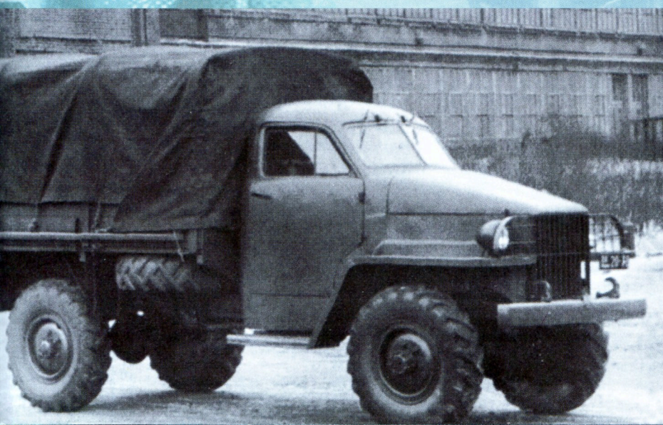
★ Армейский грузовой автомобиль ГАЗ-63 с кузовом, предназначенным для перевозки личного состава
