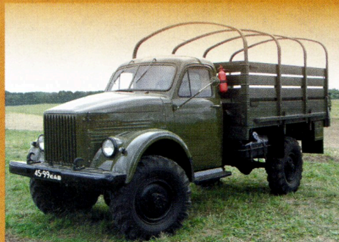
★ Армейский грузовой автомобиль ГАЗ-63 с кузовом, предназначенным для перевозки личного состава
